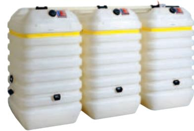
Doppelwandige Kunststoff-Sicherheitstanks (mit Innenbehälter und Auffangwanne) sind korrosionsfrei. Moderne Produkte bieten zudem eine Geruchssperre.
